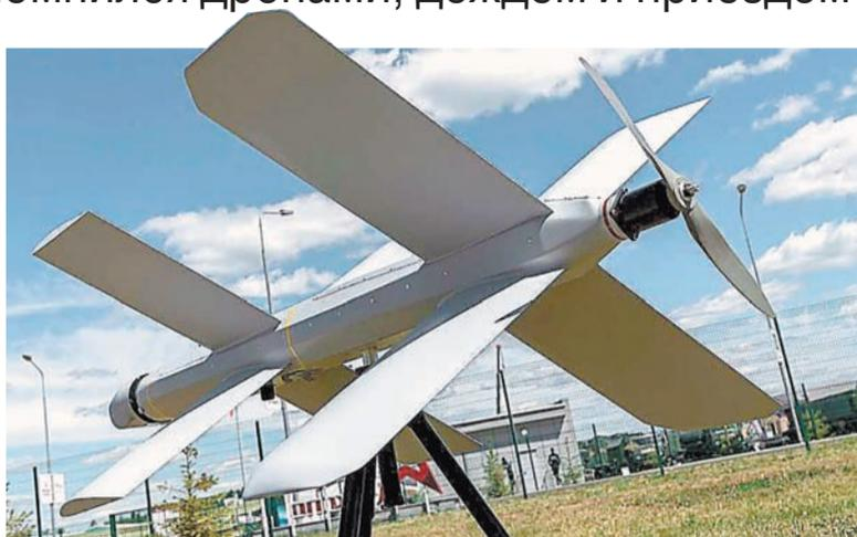
Дрон-камикадзе «Ланцет», выполненный по необычной аэродинамической схеме — с толкающим винтом (винт расположен в хвосте беспилотника), относится к барражирующим боеприпасам. Невидимый для радаров (пластик) и почти бесшумный (электромотор) беспилотник может часами висеть в небе, пока он сам или его оператор не увидит достойный объект. И тогда — спикирует и поразит цель.
