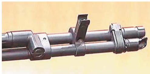
Двуствольный автомат АО-32 — ещё один необычный экспонат форума. Разработали его ещё в 1965 г., но в серию он не пошёл. Выстрел производится одновременно из двух стволов — за счёт этого улучшалась кучность огня и росла убойная мощь.
