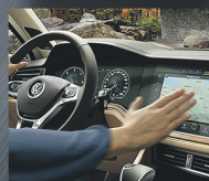
Кокпит Innovision 5 с двумя цифровыми дисплеями 12" и 15"
