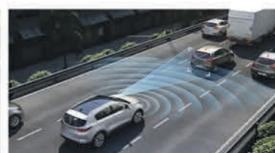
Автоматическая система экстренного торможения AEB
