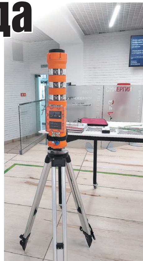
«Цифровой сигнализатор» предупреждает об опасности на железнодорожных путях.
