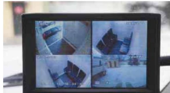
Внутри «черного воронка» — видеоглазок, который передает картинку на монитор в кабину.
