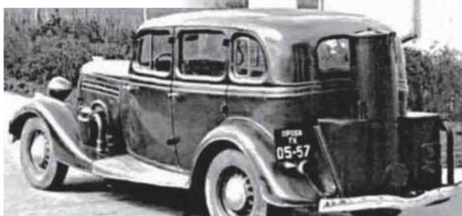
Газогенераторная «Эмка» «ГАЗ М-1».
