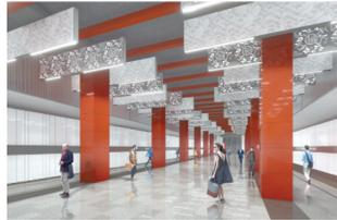
светильниками под потолком, половина панелей будет выполнена из светопрозрачного материала с лазерным нанесением орнаментов, а другая — из шлифованной нержавеющей стали с графическим рисунком. Наземный вестибюль объединит крытым пешеходным мостом с «Мичуринским проспектом» Калининско-Солнцевской линии.
