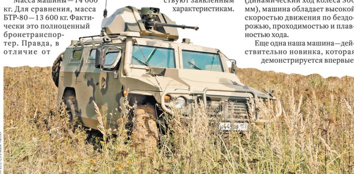
Автомобиль специального назначения АСН 233115 «Тигр-М СпН» с пушечным боевым модулем.
