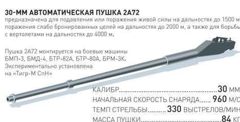
30-ММ АВТОМАТИЧЕСКАЯ ПУШКА 2А72 предназначена для подавления или поражения живой силы на дальностях до 1500 м, поражения слабо бронированных целей на дальностях до 2000 м, а также для борьбы с вертолетами на дальностях до 4000 м.
