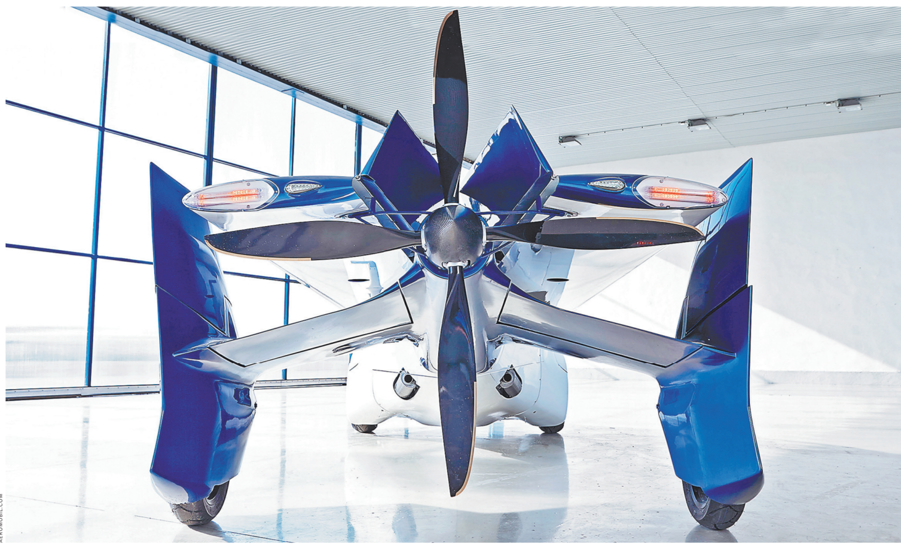
В воздухе скорость аэромобиля составит 200 километров в час. Расход топлива на 100 километров — 15 литров. Корпус будет состоять из композитных, сверхпрочных и легких материалов.
