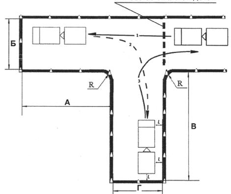
Рисунок 17. Схема и размеры упражнения № 11. Упражнение № 12 «Парковка транспортного средства и въезд с парковочного места, парковка для погрузки (разгрузки) на погрузочной площадке (платформе)».
