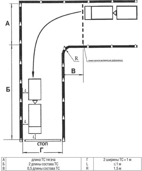
Рисунок 16. Схема и размеры упражнения № 10. Упражнение № 11 «Движение и маневрирование задним ходом, въезд в бокс задним ходом».
