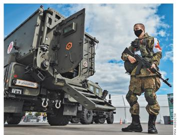
Военно-медицинскую машину «Линза» спроектировали на шасси бронеавтомобиля «Тайфун» К-53949 с повышенным уровнем защиты.
