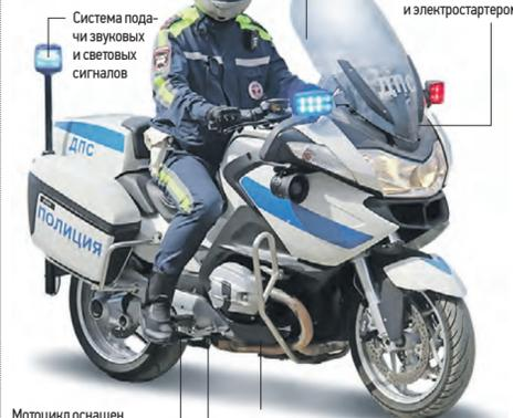
Мотоцикл оснащен карданной передачей
