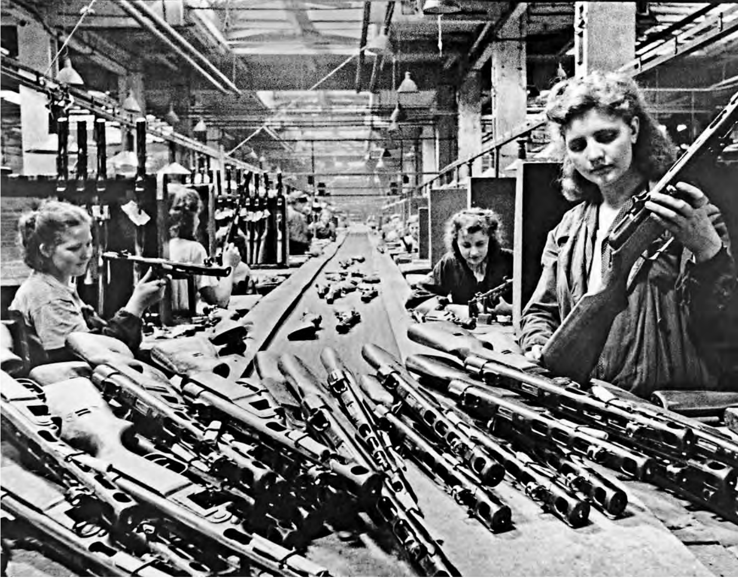
1943 год. Сборка пистолетов-пулеметов ППШ на заводе в Москве. Крупным планом — бригадир комсомольско-молодежной бригады В. Баранова
