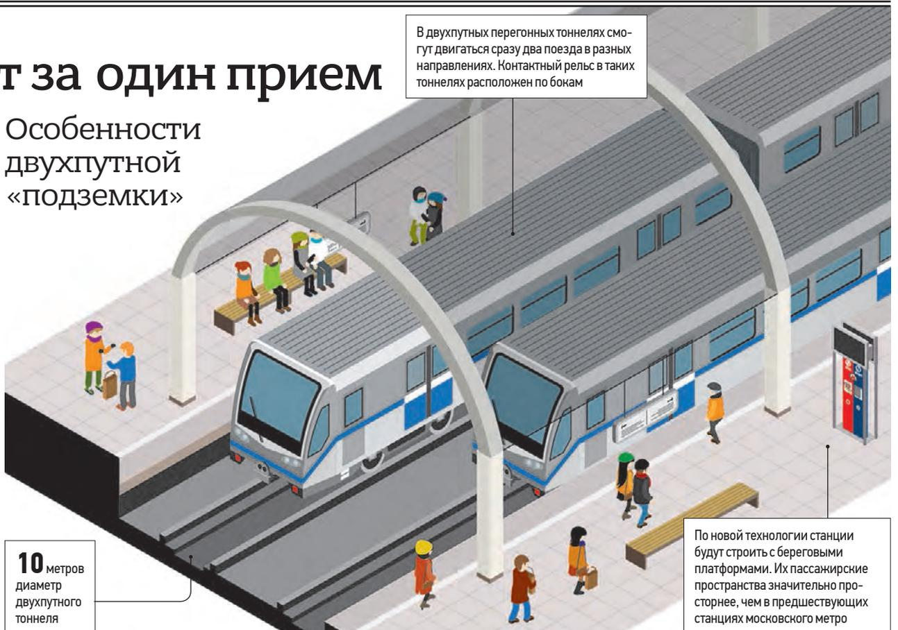
В двухпутных перегонных тоннелях смогут двигаться сразу два поезда в разных направлениях. Контактный рельс в таких тоннелях расположен по бокам
