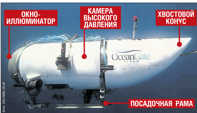
Так был устроен тот самый батискаф, который спустился к «Титанику»
